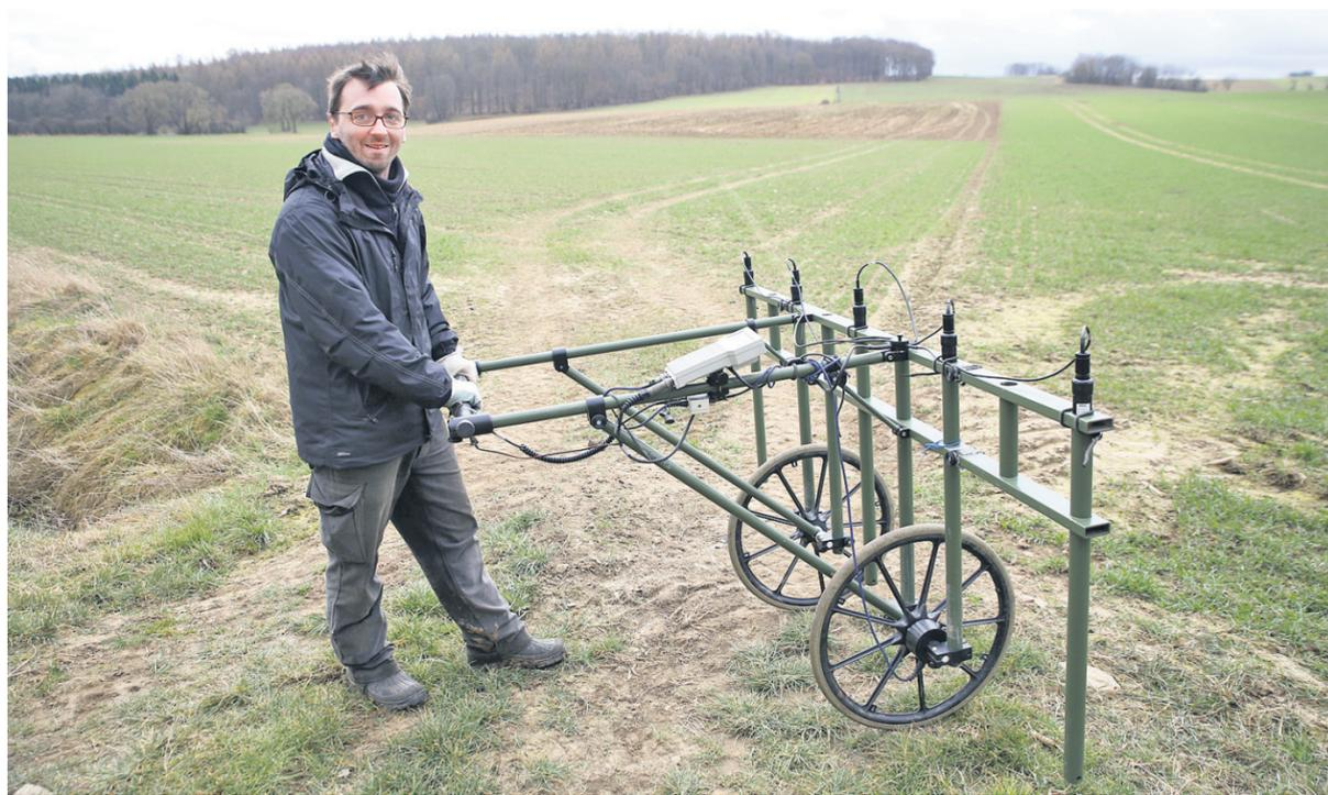
Tobias Scholz zeigt das Gestell, an dem fünf Sonden angebracht sind. Damit wird die geomagnetische Messung ausgeführt.
